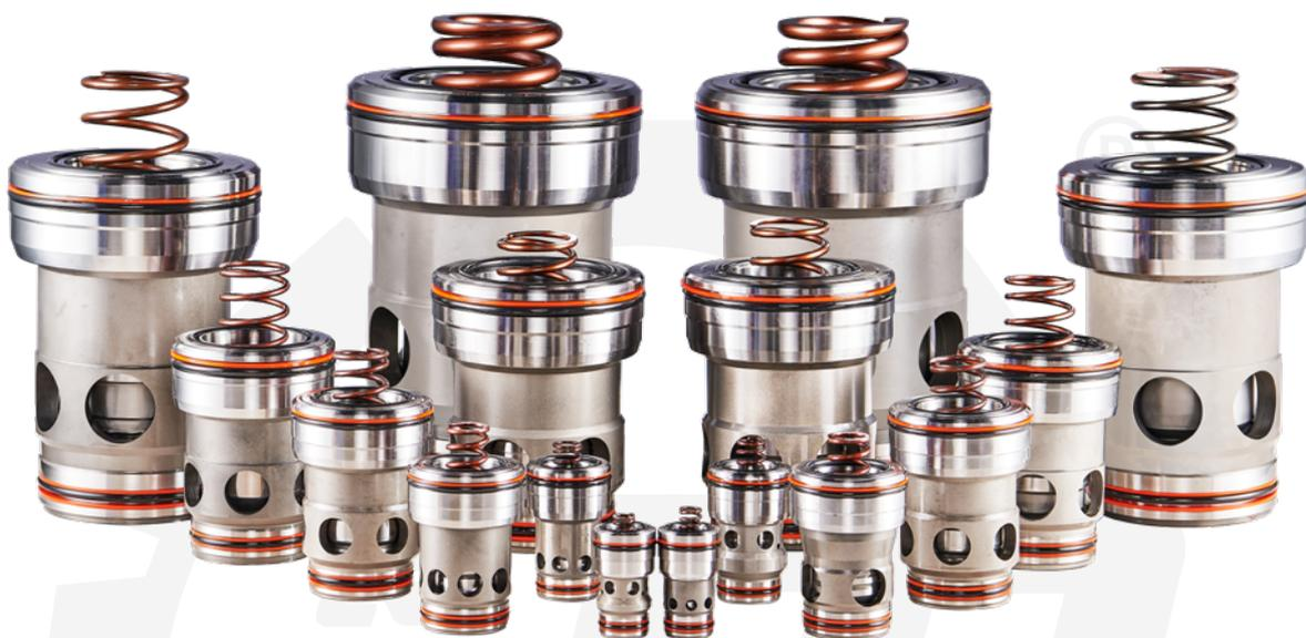
盖板式二通插装阀，一般由插件、盖板、先导元件及集成块组成。主阀组件设计成插件结构，安装在符合 ISO7368 (DIN24342,GB2877) 标准插孔的集成块内，端面用盖板封闭，通过先导元件对盖板的功​​能改变，在不改变主集成块的情况下，可获得不同种类阀的使用功能，它实际是一种多功能的复合阀。
